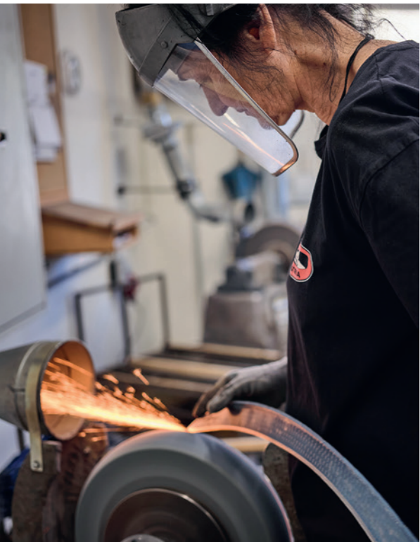
25 verschiedene Arbeitsgänge und präzise Handarbeit von gut 20 erfahrenen Angestellten braucht es vom Rohling bis zum fertigen Blatt.
