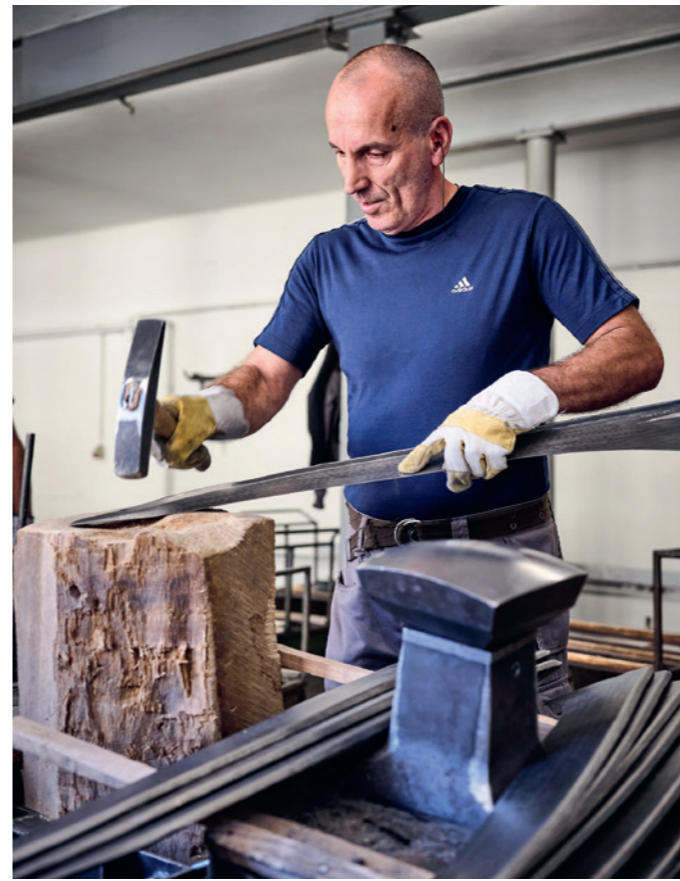
Oben: Augenmass und geübte Hammerschläge machen erst das perfekte Sensenblatt. Links und Seite 44: Der Breitner ist der König der Sensenschmiede. Dreimal wird der Zain (vorbereiteter Rohling) in einem Ölbrennofen auf 1200 Grad Celsius erhitzt und vom Breitner unter dem Schwanzhammer mit Tausenden Schlägen in die Breite getrieben. Um ein guter Breitner zu werden, braucht es drei Jahre Lernzeit und rund 2000 Stück Ausschuss.
