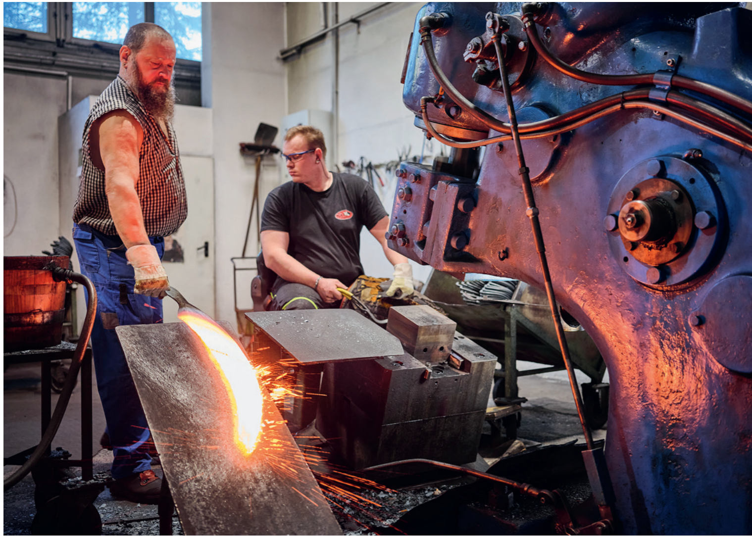
Oben: Augenmass und geübte Hammerschläge machen erst das perfekte Sensenblatt. Links und Seite 44: Der Breitner ist der König der Sensenschmiede. Dreimal wird der Zain (vorbereiteter Rohling) in einem Ölbrennofen auf 1200 Grad Celsius erhitzt und vom Breitner unter dem Schwanzhammer mit Tausenden Schlägen in die Breite getrieben. Um ein guter Breitner zu werden, braucht es drei Jahre Lernzeit und rund 2000 Stück Ausschuss.
