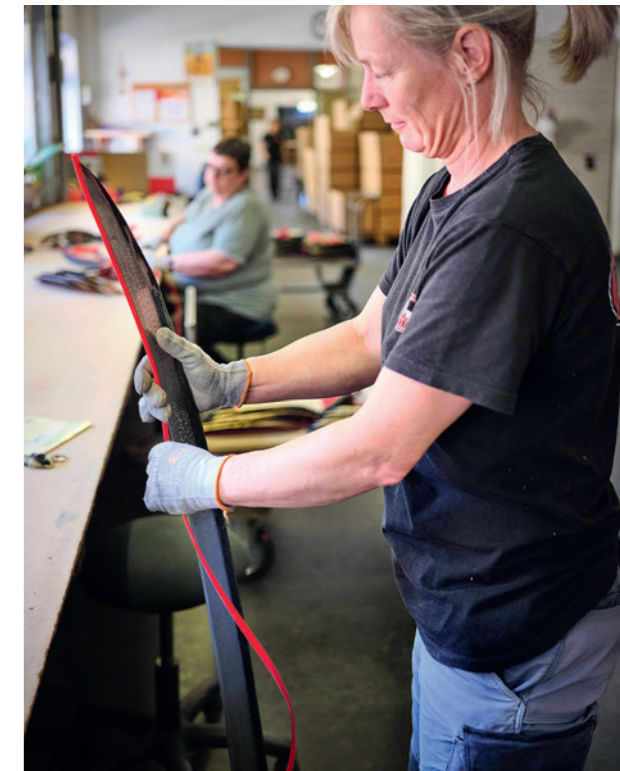
Schlussendlich wird das mähfertig gedengelte, mit Farbe, Rostschutz und Etikettierung versehene Blatt in der Konfektion schnittsicher verpackt.
