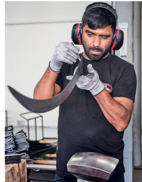
Der Stanzer versetzt dem beinahe fertigen Sensenblatt eine hübsche Prägung, welche das Material zusätzlich festigt, damit es sich nicht verdrehen kann. In der Richterei wird das Sensenblatt mit händischen Hammerschlägen und geübtem Auge perfektioniert.
