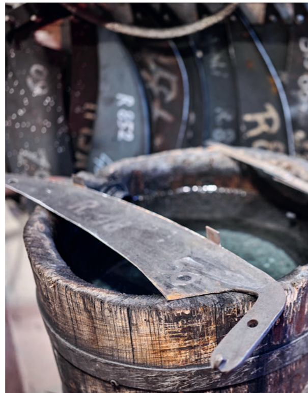
Nach dem Schmieden muss der Stahl gehärtet werden. Das Blatt wird auf über 800 Grad erhitzt und im 40–50 Grad kühlen Härteöl abgeschreckt. Der glasharte Stahl wird danach wieder langsam auf 400 Grad erwärmt, wodurch er Elastizität und Zähigkeit erlangt.
